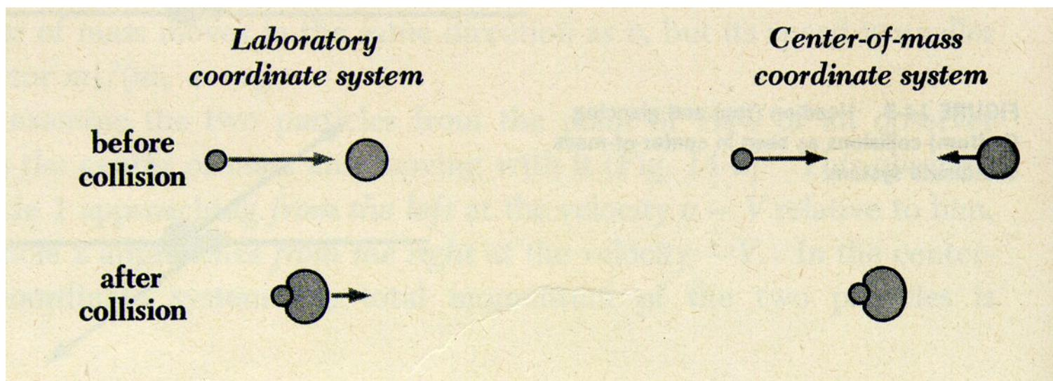
Uma colisão inelástica (fusão), onde foi dissipada a  $\Delta T_{\max}$  vista no sistema de referência do laboratório e no sistema de referência do centro de massa.
